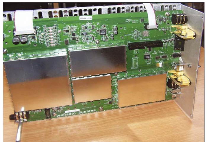
Bild 3: Die Ansicht der Trägerplatte von unten zeigt das HTRX-Board. Hermetisch abgeschirmt sind Frequenzaufbereitung, 11-poliger Tiefpass, RX-Mischer mit 24-Bit-A/D-Umsetzer sowie Firewire-Interface.
