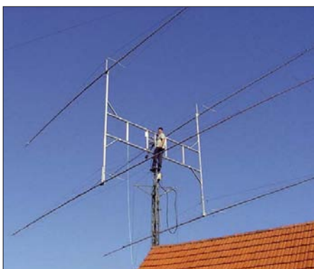
DK3EE bzw. DK3T arbeitet mit einer Gruppe von vier 24-Element-Yagis von M 2 . Die jeweils 16,70 m langen Antennen erzeugen einen Gesamtgewinn von etwa 23 dB. Foto: DK3EE
