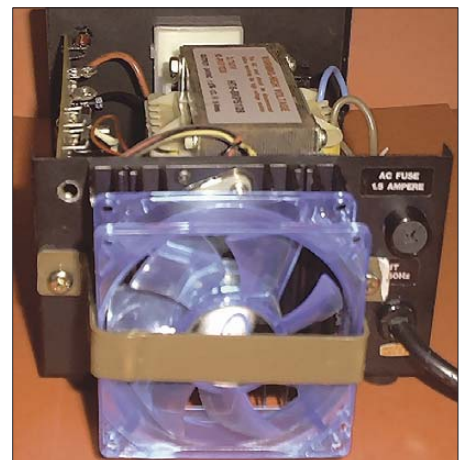
Bild 3: Der Lüfter wird von außen direkt auf den Kühlkörper des Netzteils gesetzt und mit einem Bügel an der Rückwand befestigt. Seine Anschlüsse führen zur Zusatzplatine im Gehäuseinneren.
