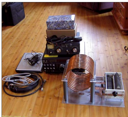
Was für ein Zufall: die Heimstation mit Antennenanpassgerät und Hochgütespule (für 80 und 160 m) tauchte ganz „unerwartet“ im Gepäck auf.
