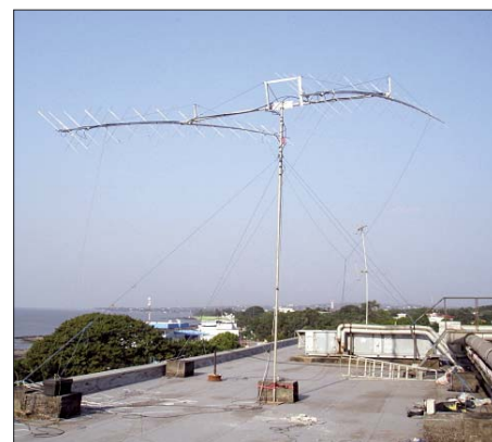
Die zwei Yagis auf dem Hoteldach; vor allem beim Monduntergang übers Meer stiegen die Feldstärken kräftig an. Foto: AA7A
