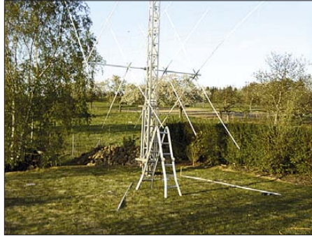
Bild 10: Der Umrechnungsfaktor 0,95 für isolierte Litze erwies sich als zu stark verkürzend, hier musste neu gebohrt und verlängert werden.
