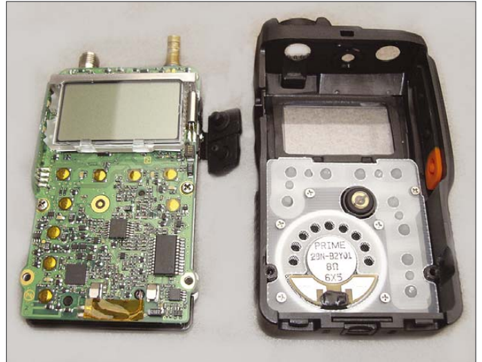
Bild 5: Die Tasten liegen unmittelbar auf der Platine. Daneben angeordnete LEDs durchleuchten ihre Abdeckung im Gehäuse.
