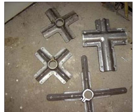
Bild 9: Haltekreuze und Mastbefestigung
