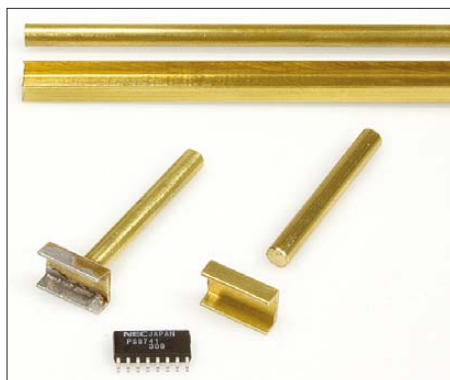
Bild 1: Die Länge des 6 mm breiten U-Profiles richtet sich nach der Pinanzahl des ICs im SO-Gehäuse. Für acht Anschlüsse je Seite sind 11 mm ausreichend.
