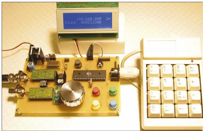
Bild 7: Testaufbau von DL1FAC mit zwei AD9912-DDS-Hybrid-Modulen
