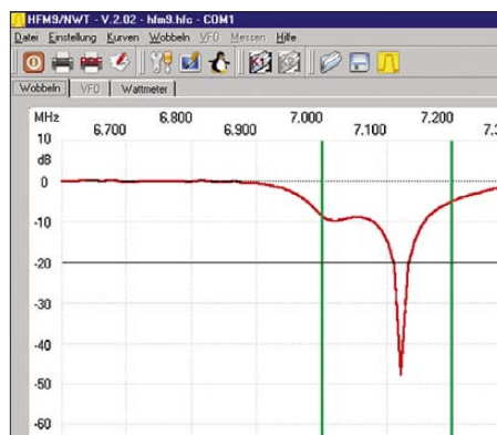
Bild 9: Ungünstiger Abgleich: Die Reflexionsdämpfung erreicht zwar um 7,125 MHz fast 50 dB, bleibt aber ansonsten unter 10 dB.
