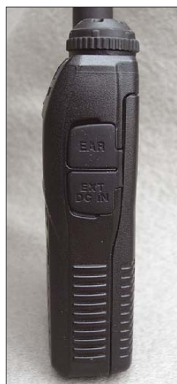
Bild 3: Zur Lade- bzw. Stromversorgungsbuchse auf der rechten Seite gesellt sich nun noch eine Klinkenbuchse für einen Kopfhörer. UKW-Empfang ist in Stereo möglich! Nach wie vor gibt es auf der Oberseite eine vierpolige Buchse zum Mikrofonanschluss.
