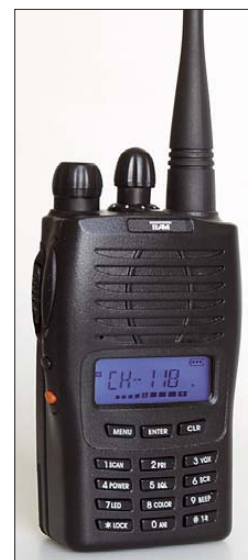
Bild 2: Das TeCom-PRO bietet eine analoge Sprachverschlüsselung und die Ansage sämtlicher Bedienschritte.
