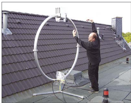
Bild 1: Magnetschleifenantenne in senkrechter, d. h. konventioneller Montage
