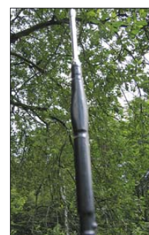
Bild: 4 Aufgeblähter Schrumpfschlauch im oberen Teil der Verlängerungsspule (Tageslichtfoto) Foto und Screenshots: DL9OBL
